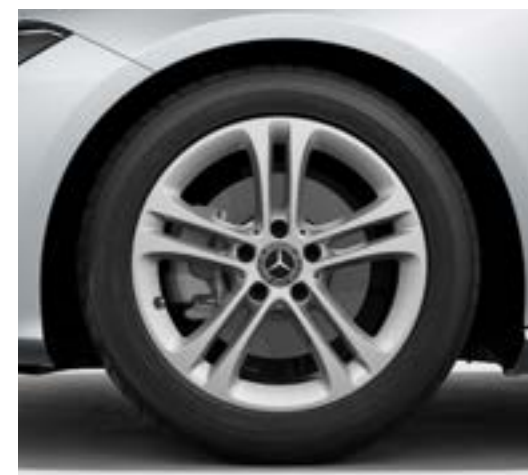
R62 - Cerchi in lega leggera da 43,2 cm (17") a 5 doppie razze A richiesta (CHF 0.-)
