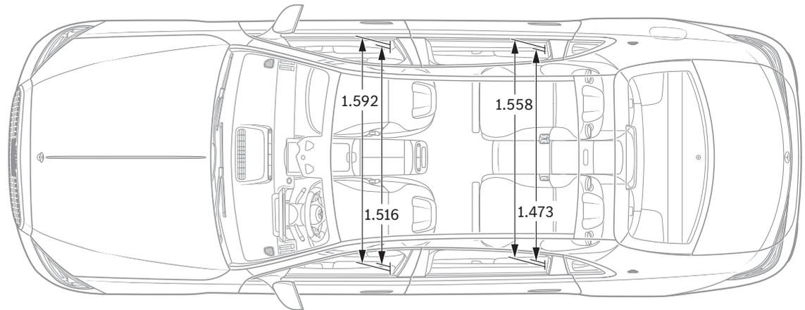
Alle Angaben in Millimetern. Die abgebildeten Masse sind Mittelwerte. Sie gelten für Fahrzeuge in Grundausstattung und in unbelastetem Zustand.
