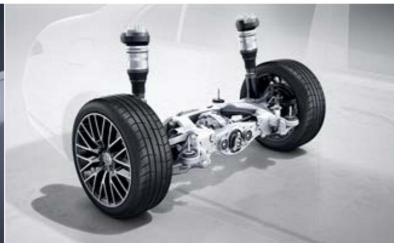
201 – Hinterachslenkung mit Einstellung des Lenkeinschlags auf 4,5°
